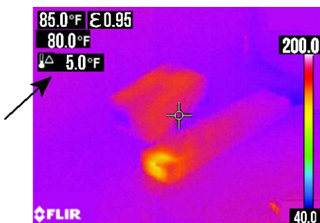
Fig. 8-4 Eksempel på aflæsning af type K-/IGM-temperaturforskelle
