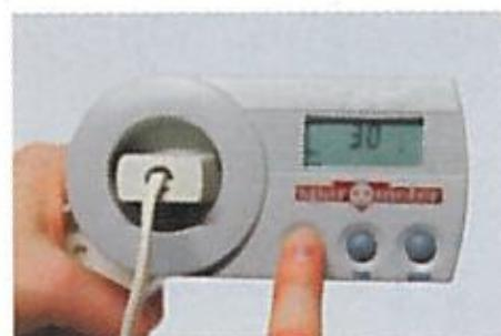
2. Ved at trykke på START/STOP kan du nu skifte mellem 7 døgn, 30 døgn, 0 døgn (= valgfri måleperiode fra tryk på START til tryk på STOP) og retur til 1 døgn.
