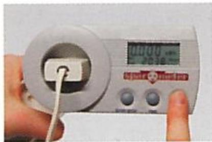
**4 B** Den aktuelle spænding (Volt) og netfrekvens (Hz)
