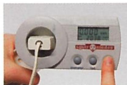
**4 D** Den aktuelle "tilsyneladende" effekt (VA) og effektfaktor (cos phi). (Teknisk uddybning - se mere på [www.sl-electric.dk](http://www.sl-electric.dk)).
